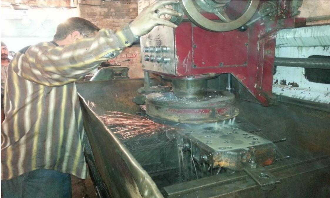
شكل رقم 2: يوضح عملية ازالة طبقه 1 ملم من المعدن
